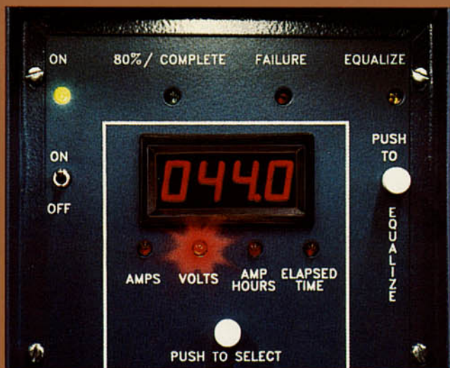
Output Voltage —displays actual voltage of a battery \pm 0.1 volt.
